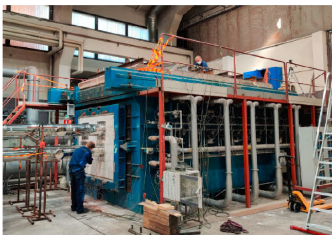
Přípravné práce pro horizontální zkoušku
